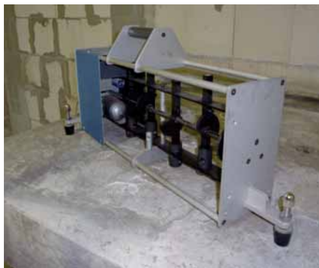
Normhammerwerk nach DIN EN ISO 10140
