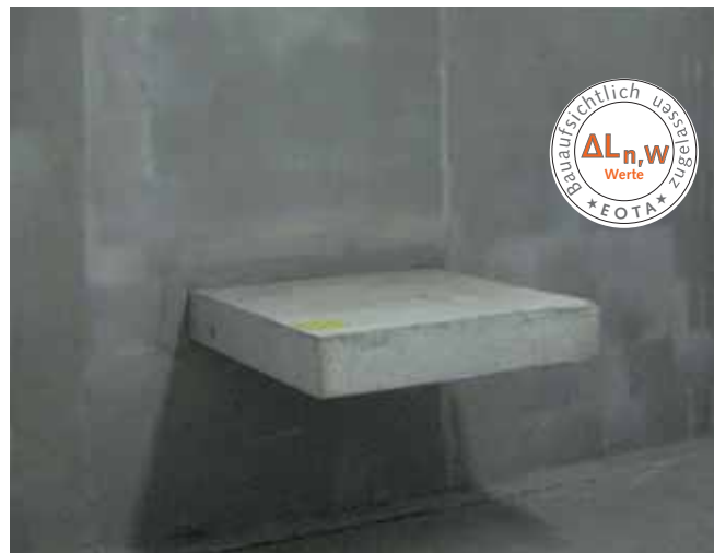
Prüfstand in Anlehnung an DIN EN ISO 10140 mit eingebautem Element
