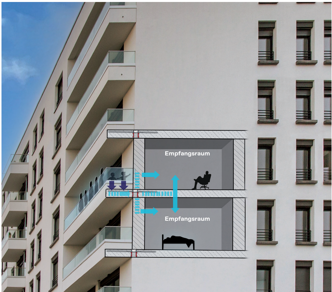
Abbildung: Wandkonstruktion mit Balkon: Darstellung Trittschallverlauf
