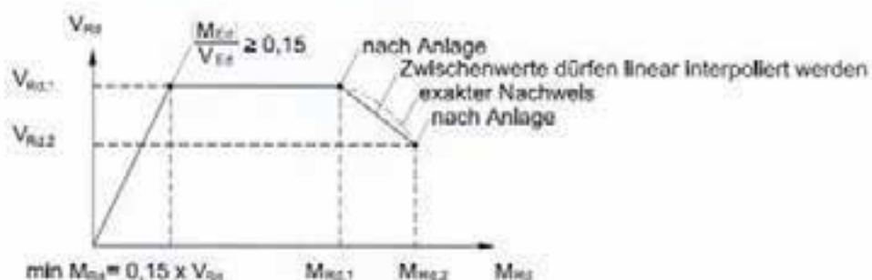
Bild 2.3 HIT-HP/-SP MVX Tragfähigkeit → M-V-Interaktion / qualitativ
