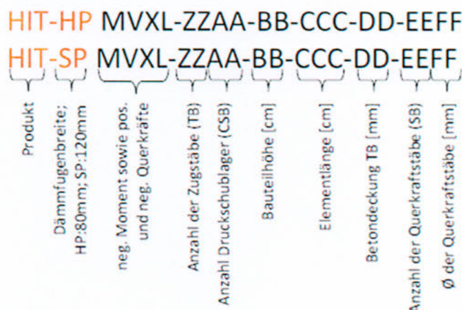
Bild 2.3 Bezeichnung der HIT-HP/SP MVXL Plattenanschlüsse / [1]
