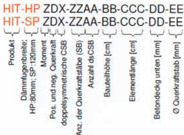
Bild 2.4 Bezeichnung der HIT-HP/SP ZDX Plattenanschlüsse / [1] Z = ZERO Moment
