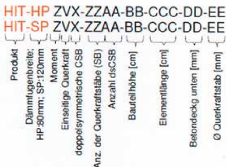
Bild 2.3 Bezeichnung der HIT-HP/SP ZVX Plattenanschlüsse / [1] Z = ZERO Moment
