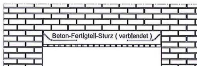
Bild 2.2 FSW – Fertigsturzabfangung / Anwendungsbeispiel
