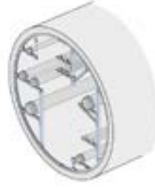
Rörstöd i arbetstunnlar
