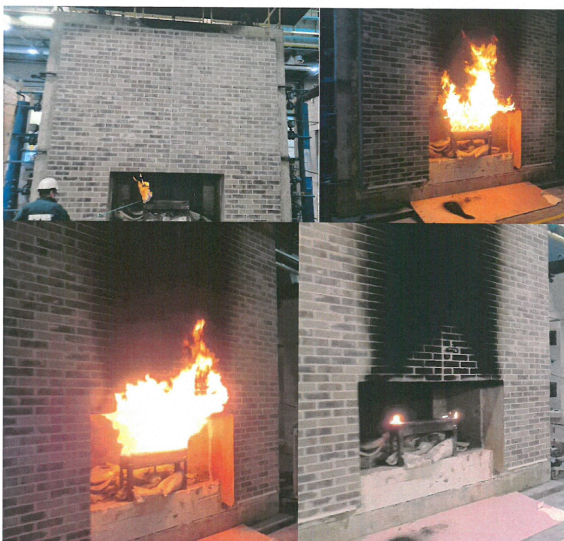
Rys. 49. Widok okładzin ceramicznych, klinkierowych przed badaniem, w 80 i 121 minucie badania oraz po badaniu; archiwum ITB
