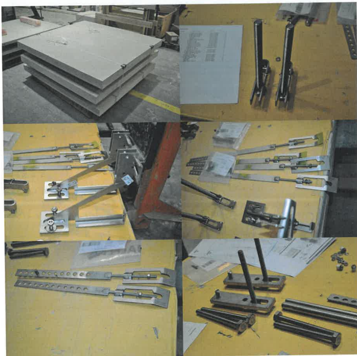
Rys. 32. Elementy składowe próbki do badań
