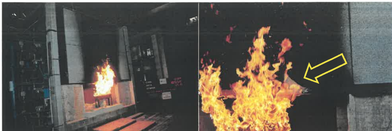
Rys. 39. Widok próbki podczas badania – 85 minuta, uszkodzony fragment płyty 8
