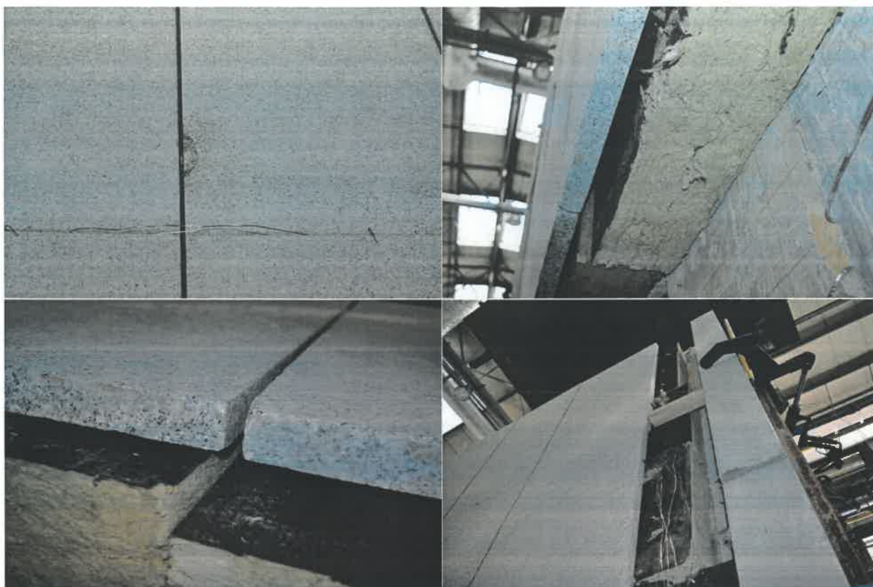
Rys. 32. Widok gotowej próbki przed rozpoczęciem badania - detale.
