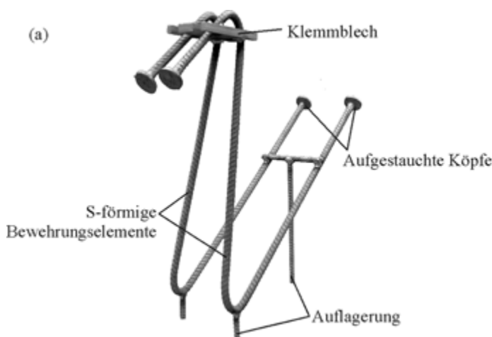
Bild 1 Neuartiges Durchstanzbewehrungselement New punching shear reinforcement element
