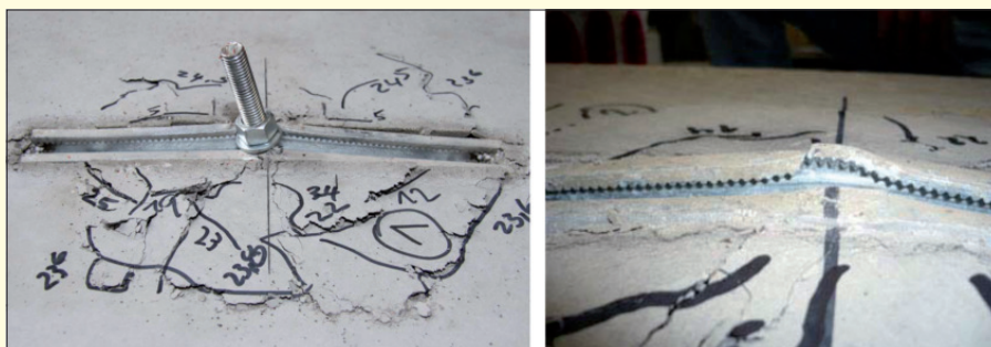
Bild 9. Versagensform für zentrische Zugbelastung in Feldmitte: Globale Biegung der Ankerschiene (links) und lokales Aufbiegen und Reißen der Schienenlippe
