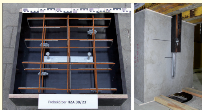
Bild 4. Schalung und Bewehrung des Probekörpers der HZA 38/23 Ankerschiene (links) und dessen Einbauzustand in der Versuchsvorrichtung (rechts)
