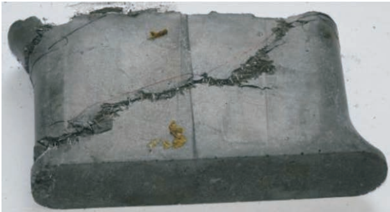
Bild 5 Bruchbild bei Druckschublagerversagen Fracture picture of compression shear bearing failure
